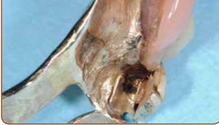
**Abb. 4:** Spaltkorrosion an Lotstellen bei herausnehmbarem Zahnersatz
